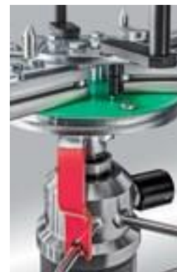
Chốt an toàn (đỏ) Với van quay (đen)
