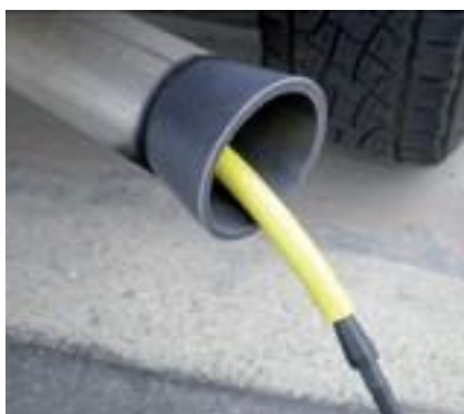
Leakfinder® có thể xác định rò rỉ trên hệ thống đường ống xả
