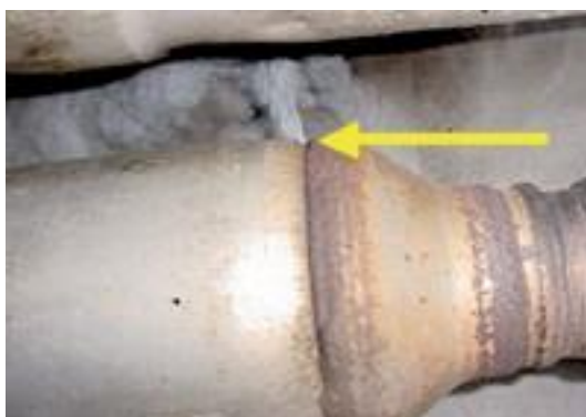
Leakfinder® có thể xác định rò rỉ trên hệ thống đường ống xả
